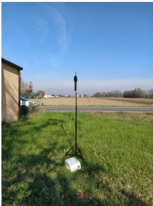
Figura 3 - Esempio posizionamento fonometro RUM_01 e RUM_02
